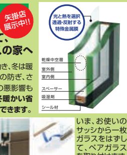
いま、お使いのサッシから一枚ガラスをはずして、ペアガラスを取り付けます。
